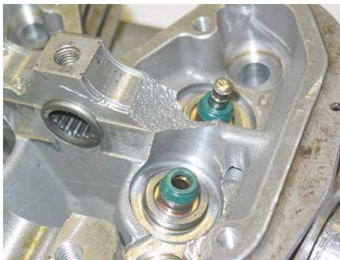
* Poškozený starý typ hlavy
